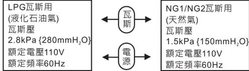
請務必使用熱水器規格表上標示之瓦斯種類(瓦斯種類之區分)、電源(電壓、頻率)。瓦斯種類中區分為LPG、NG1及NG2，建議瓦斯壓以標準壓使用，確保機器及使用安全。
