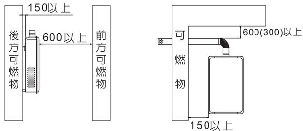
※ ()內是將防熱板安裝在四周牆壁、天井時之尺寸，防熱板請使用厚度3mm以上之非金屬不燃材。(單位: mm)
